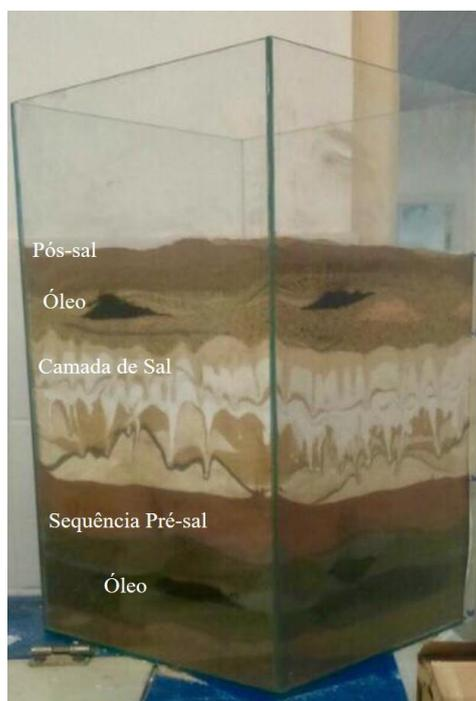
Figura 6. Modelo esquemático da Sequência da Camada Pré-Sal montada em aquário de vidro.
